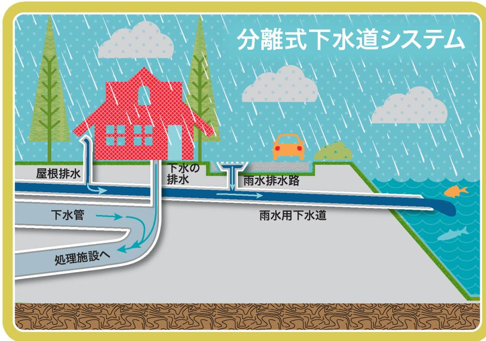
現在、キング郡の都市は別々の配管を建設しています。1つは下水を処理施設に運ぶためのもので、もう1つは雨水を最も近い水域に運ぶためのものです。ただし、シアトルの最も古い地区にはまだ合流式下水道が残っています。
