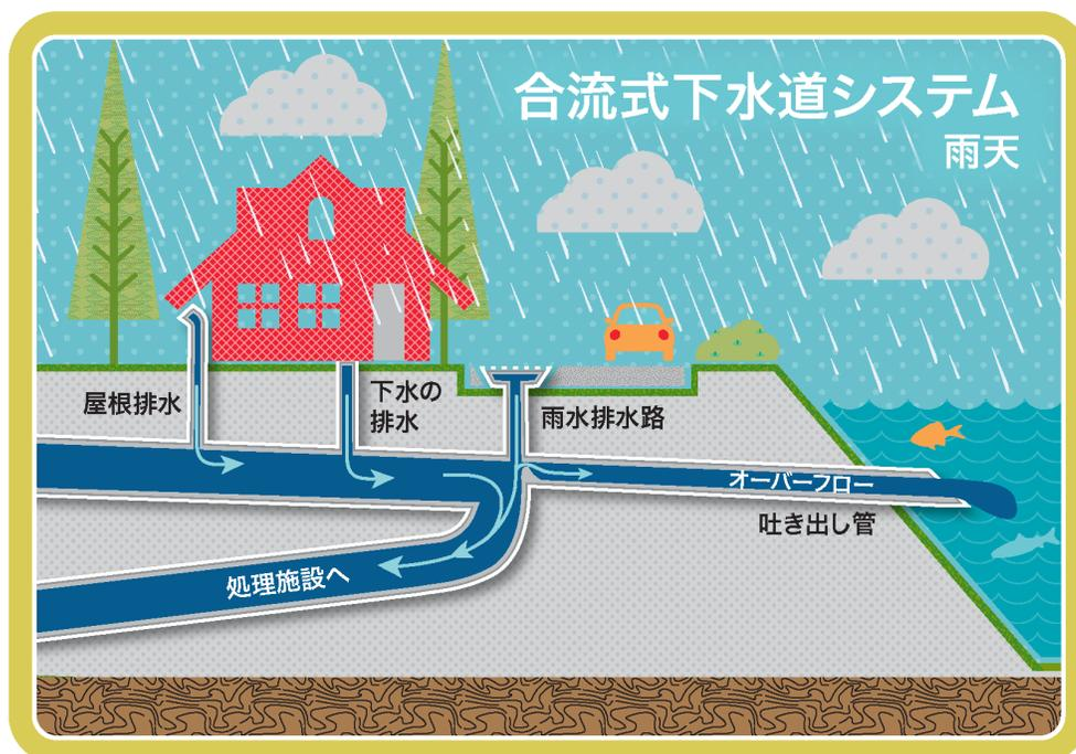
「合流式下水道」に大雨が充満すると、放出ポイント（吐き出し管）から、余分な下水と雨水を河川、湖、またはプュージェット湾に放出します。
