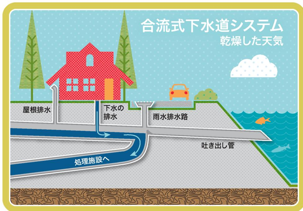
その後、技術者はこの水を環境に放出する前に、浄化する処理施設を建設しました。そして、これらの水をすべて廃水処理プラントに運ぶために、「合流式下水道」と呼ばれる大きな配管を建設しました。
